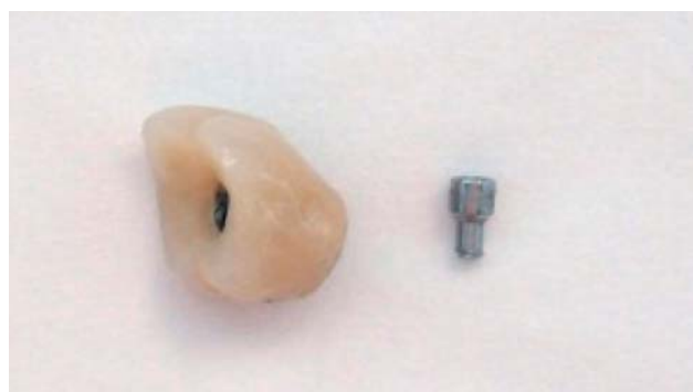
Figura 5. Detalle de un tornillo de clínica fracturado de corona sobre implante.
